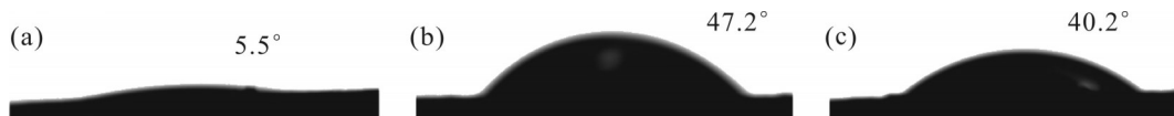
Fig. 3 Water contact angle images of the samples: (a) TiO 2 ; (b) TiO 2 -KH560; (c) TiO 2 -PHMB
